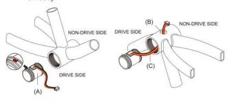
2. 將溝槽中管置入五通管中,置入時應同時輕拉電線,使其置於五通管中央偏左位置,以避免左牙碗旋入時,帶動溝槽中管造成損害。
