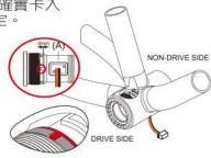
6. 選中天心(E)R端方向 ,插入溝槽中管(A) 貼合左牙碗軸承(F) 端面。
