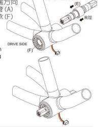
7. 以順時針方向將右牙碗 軸承(G)旋入五通管, 並確實鎖緊固定。 注意:右牙碗為 (BC 1.37"x 24T)
